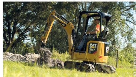
Compacte, la minipelle 301.7 CR de Caterpillar délivre une puissance nette de 15,7 kW. Son poids d'exploitation maximum atteint 1 915 kg, avec une configuration canopy. Elle affiche une profondeur de fouille de 2 540 mm et une portée au sol maximale d'environ 4 060 mm. Ce modèle est équipé d'une hydraulique à détection de charge avec une pompe à cylindrée variable offrant un débit de 66 L/min.
