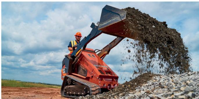
Ditch Witch France élargit sa gamme avec le SK1750, successeur du SK1550. Doté d'un moteur diesel Yanmar® 45 cv Stage V, il offre une capacité de levage de 2 672 kg au sol et 935 kg à 240 cm. Son système de chenilles TriTrax, avec galets repositionnés, améliore stabilité et longévité. Côté confort : écran LCD couleur, levier d'accélérateur manuel et plateforme opérateur spacieuse. Le SK1750 sera présenté en avant-première au salon Paysalia.
