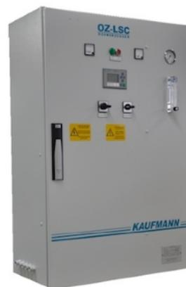
Générateur d'ozone à partir d'air comprimé et oxygène OZ LSC
