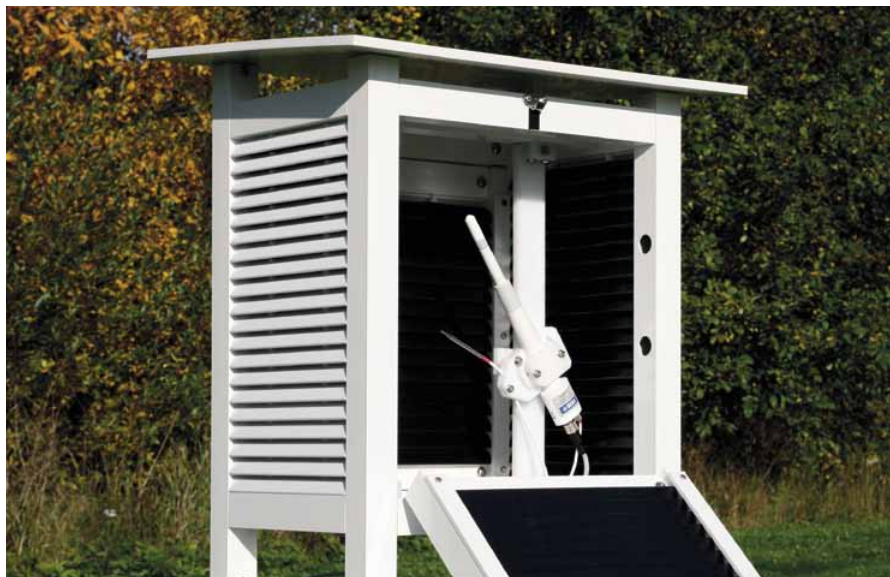
La sonde HMP155 avec le capteur HUMICAP®180R très stable et une sonde de température supplémentaire.
