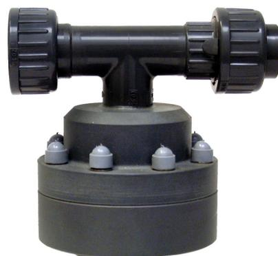
La structure du casse-vide est similaire à celle d'un clapet anti-retour d'hydro-injecteur. Mais la dépression d'ouverture n'est que de 0,05 bar (par rapport à 0,1 bar pour le clapet anti-retour de l'hydro-injecteur) ; le casse-vide permet ainsi à de l'air de pénétrer dans la conduite avant toute aspiration accidentelle de chlore.
