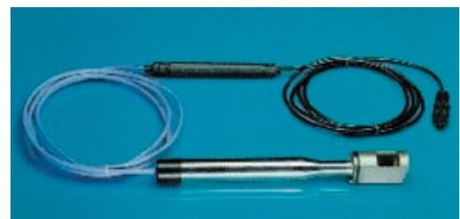
Le câble entre le capteur et l'amplificateur-câble ne doit en aucun cas être coupé ou raccourci.
