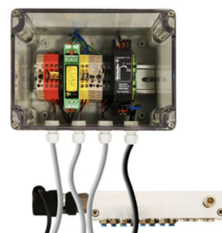
Détection casse et débris de gaine quartz OPTIDETECT
